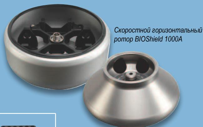
Скоростной горизонтальный ротор BIOShield 1000A
