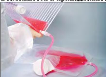
Заполняют или опорожняют с помощью соединения, ориентированного на простое включение, и работают с полузакрытой системой.
