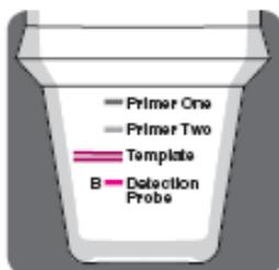
Детекция в однофазной системе иммобилизованных амплифицированных продуктов с помощью стрипов NucleoLink
