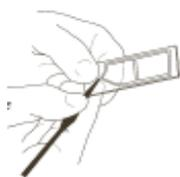
Удаление прокладки. Под один из углов прокладки вставляют кончик тонкого лопатообразного шпателя или подобного инструмента. Не растягивая и не разрывая прокладку, аккуратно отделите её от подложки.
