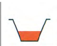
Реактив и образец смешиваются благодаря специальному покрытию поверхности лунок
