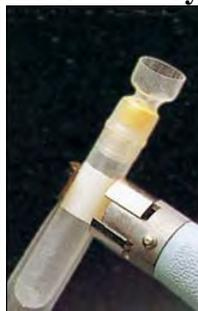
Соломку Nunc CryoFlex прижимают, аккуратно нагревая струёй горячего воздуха с помощью термоусадочной трубки
