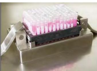
*Инструмент для отбора пробирок Nunc имеет скошенный угол для гарантии правильной ориентации штатива, когда рычаги отпускают его и поднимаются для быстрого повторения цикла. Штатив с оставшимся материалом быстро возвращается в холодильник, чтобы избежать заметной разморозки.*
