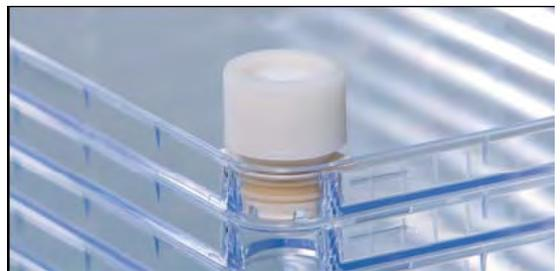
*ПРИСОЕДИНЯЙТЕ* контейнер со средой к нашему стандартному порту с помощью стандартного коннектора для клеточной фабрики. Получается полужакрытая система для производства в соответствии с GMP.
