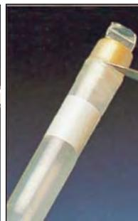
Удалите Nunc CryoFlex, обрезав по краю винтовой крышки
