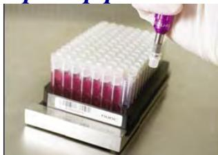
Удаление крышек легко автоматизировать с помощью муфты, захватывающей крышку. Наши партнёры предлагают устройства для снятия крышек на 96 мест при помощи этой методики
