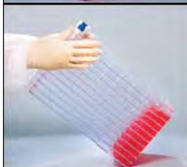
4. Осторожно переместите клеточную фабрику EasyFill с поднятым вверх впускным клапаном в горизонтальное положение для инкубации. При работе беритесь за неё сбоку. – не берите клеточную фабрику за верхний ободок.
