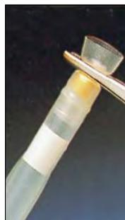
Зажмите или уплотните нагретые концы. Подрежьте лишнюю длину трубки и по желанию оплавьте зажатые концы
