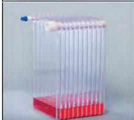
3. Клеточную фабрику EasyFill поворачивают на 90° так, чтобы впускной клапан оказался сверху. В каждую камеру распределяется равное количество среды.
