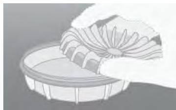
*Вогнутую крышку можно использовать для отделения от крышки приклеившегося образца*
