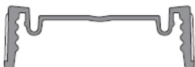
*резьбовая уплотнительная завинчивающаяся крышка*
