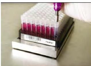
Крышки удаляют с помощью отвёртки с одним или несколькими наконечниками. Ампулы закреплены в штативе для уверенности, что они не выпадут при транспортировке или хранении в лаборатории. Закреплённая пробирка также остаётся в штативе при поднятии крышки и снятии отвёртки.
