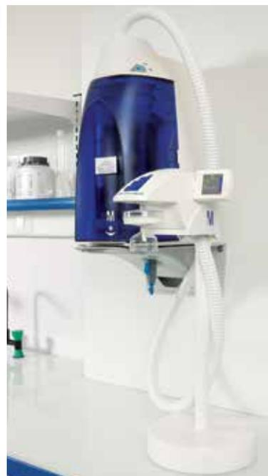
\*Системы Direct-Q® 5 и Direct-Q® 8 предназначены для использования с внешним накопительным баком вместимостью 30 или 60 литров.
