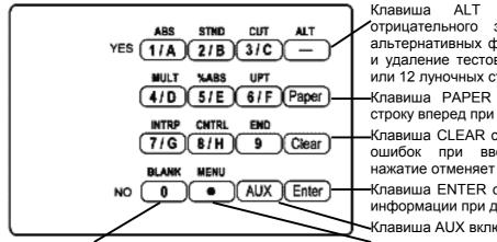
Клавиша ALT используется для ввода отрицательного знака и доступа к списку альтернативных функций, таких как сохранение и удаление тестов, установка часов и выбор 8 или 12 луночных стрипов.
